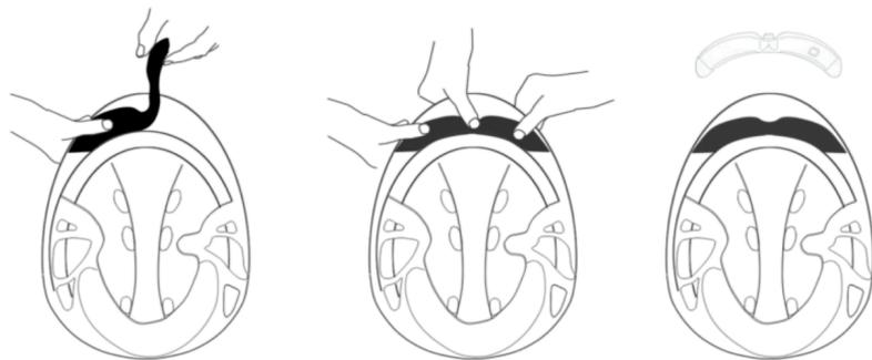
*La pose de l'attache velcro doit se faire dans un environnement tempéré non humide (environ 15°C) afin de garantir un maximum d'adhésion à la colle. Il est conseillé d'attendre au moins 4h avant de coller la fixation velcro sur son support propre et sec !*
